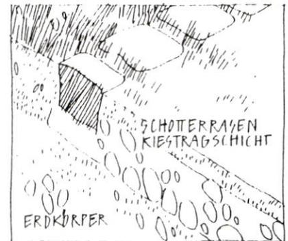
Durchlässige Beläge sind beispielsweise Schottergras, durch Gittersteine befestigter Rasen und offenfugiges Pflaster.
